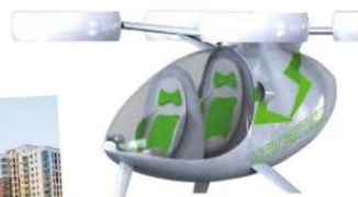
L'Hovertaxi, un taxi aérien 100 % Hydrogène. Ce modèle possède une autonomie de 1 h à 120 km/h.
